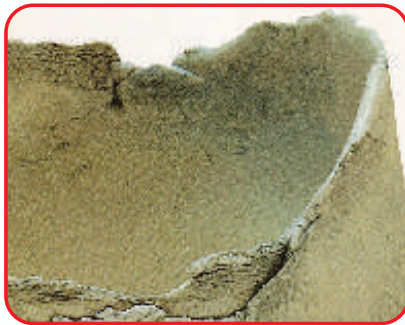
شكل ( ٥٢ ) : يوضح نتائج أخطاء التجفيف ( تشقق ).
