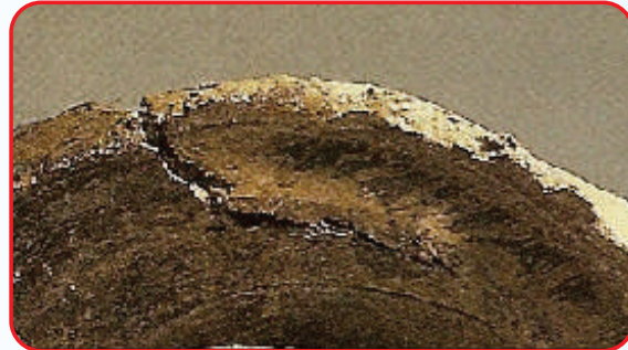
شكل ( ٥٢ ) : يوضح نتائج أخطاء التجفيف ( تشقق ).
