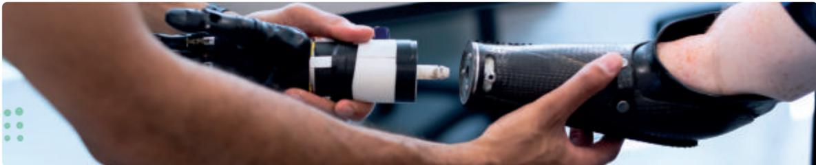
شكل 3.66: اختبار النموذج الأولي للذراع الصناعية
