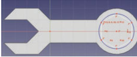
2 استخدام أداة إنشاء شكل سداسي (Create hexagon) لتصميم الشكل السداسي، ثم استخدام أداة التجويف (Pocket) لإنشاء ثقب سداسي الشكل في مفتاح الربط، ويجب أن يكون سُمك المفتاح 5 ملليمتر.
