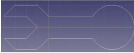
1 استخدام أدوات إنشاء خط (Create line) وإنشاء خط متصل (Create polyline) لإنشاء محيط مفتاح الربط. استخدام أداة إنشاء قوس (Create arc) لإنشاء هيكل مفتاح الربط.
