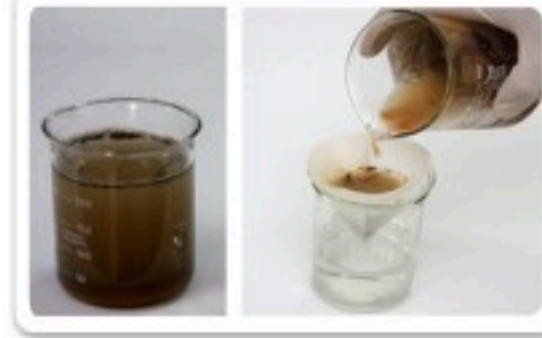
الشكل 1-1 يمكن فصل المخلوط المعلق إذا ترك دون تحريك فترة من الزمن، أو فصله بالترويق.
