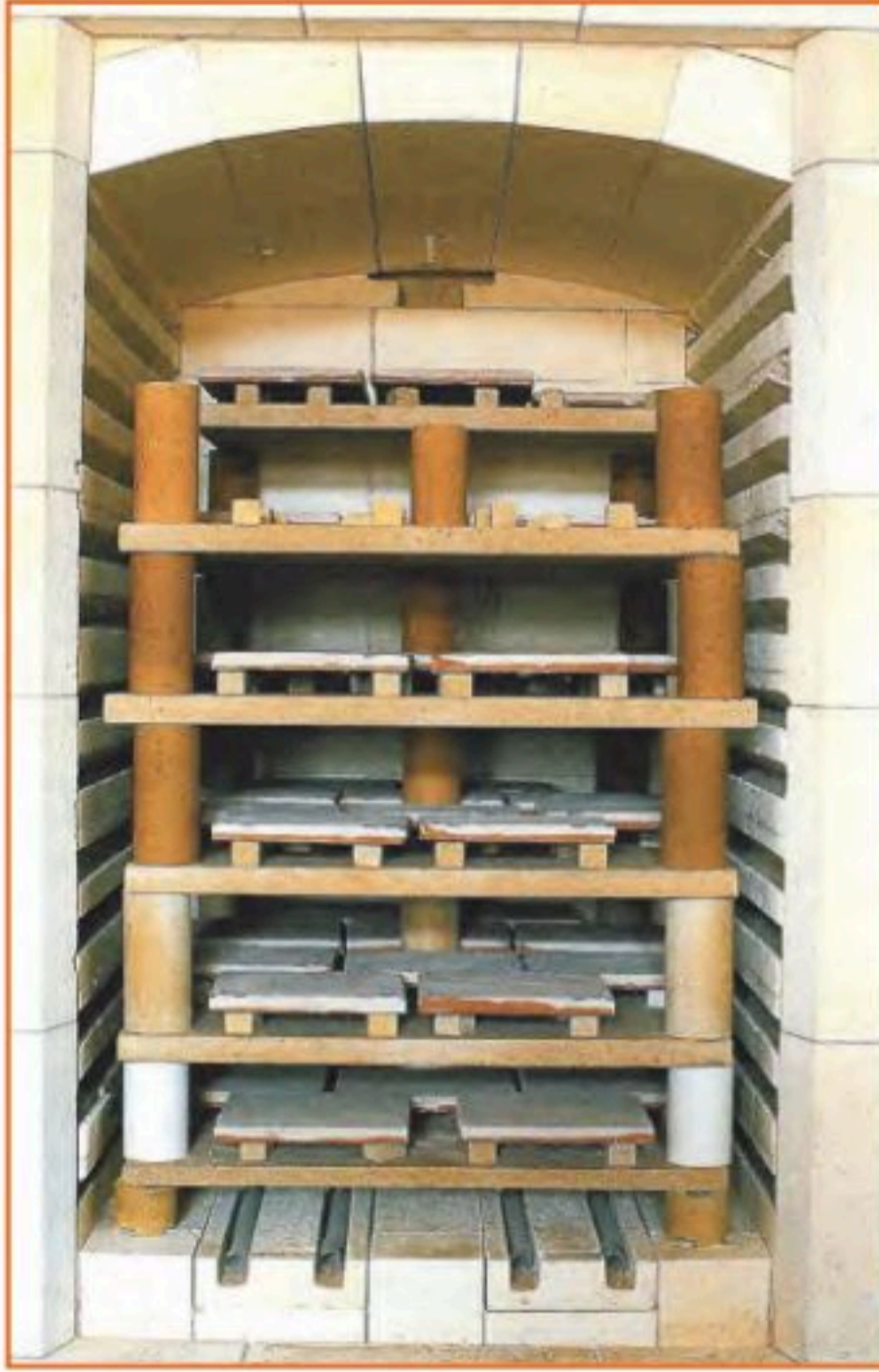
الشكل (٥٧): طريقة رص القطع الطينية في الفرن الكهربائي.
