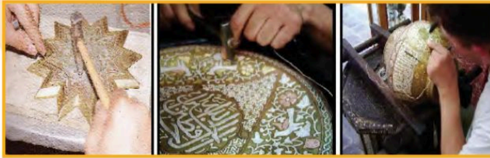
الشكل (٨١): طريقة التكفيت
