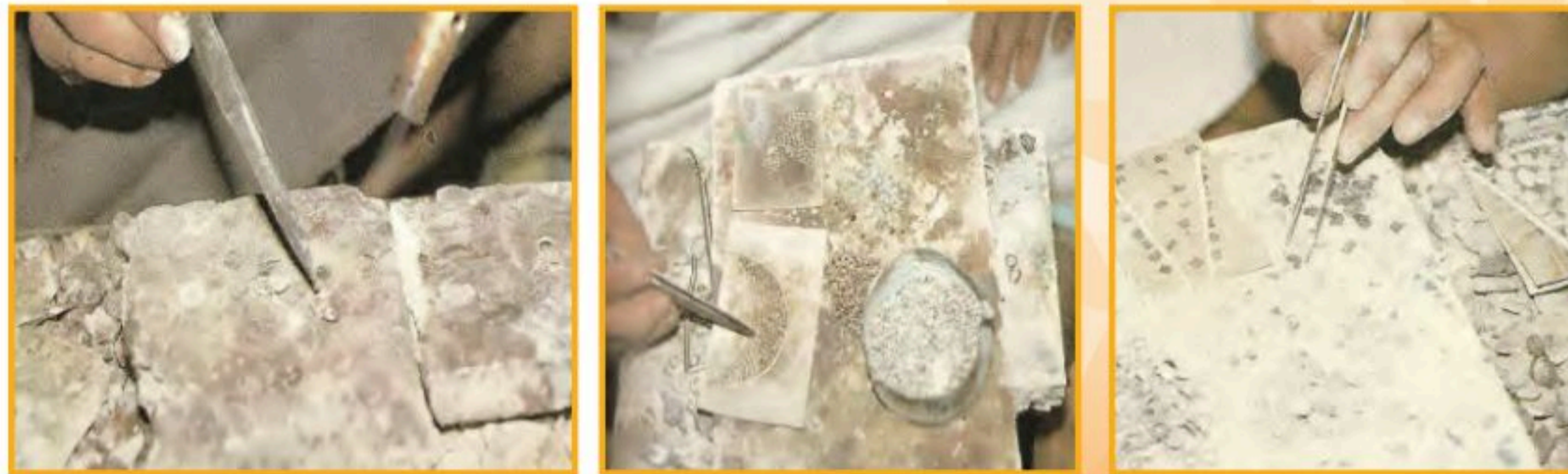
الشكل (١٠٣): عملية اللحام وتثبيت العناصر
