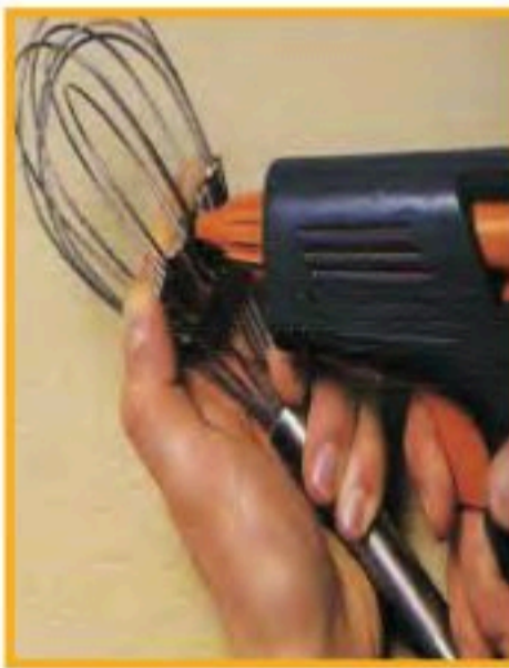
الشكل (٩٢): النوع الثاني (لحام البارد باستخدام الصمغ).
