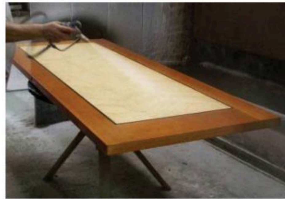
الشكل ( ١٦١ ) : باب خشبي مغطى بثلاثة أنواع من قشرة الخشب . ويلاحظ أن الحرفي يقوم بتغطيته بطبقة من الورنيش لحمايته .
