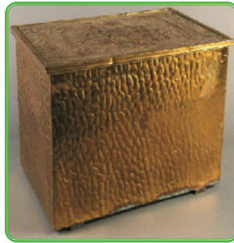
الشكل (١١٣): الطرق بالدق بالأزاميل.
