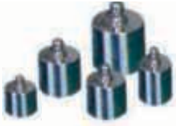
▲ كتل معيارية لإيجاد كتلة المادة باستعمال الميزان ذي الكفتين.
