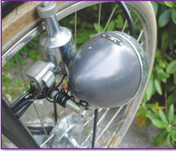
يتصل المولد الكهربائي بعجلة الدراجة
