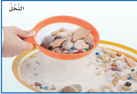
يستخدم المنخل لفصل مواد مختلفة الحجم.
