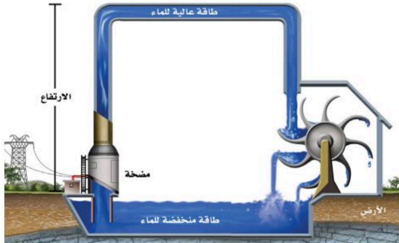
الشكل ٥ تزداد طاقة وضع الجاذبية الأرضية للماء عند رفعه فوق سطح الأرض باستخدام المضخة.
